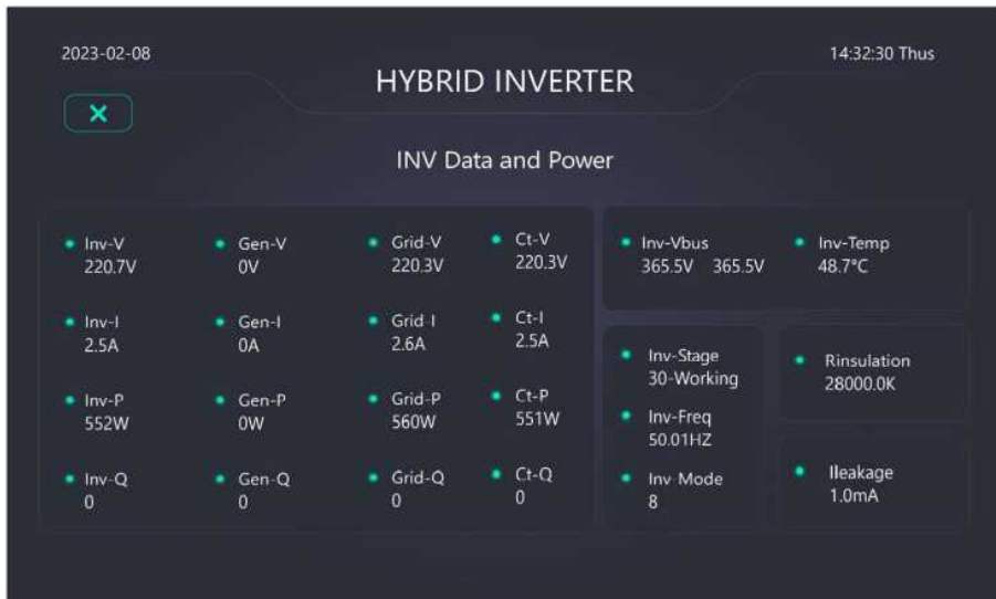
Рисунок 3.8. Екран робочих даних інвертора
