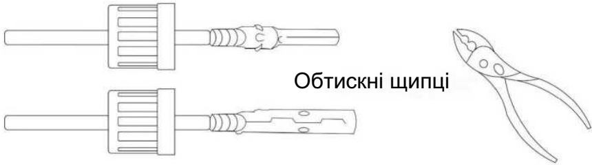
Рисунок 2.13. Обтискання металевого контактного наконечника
