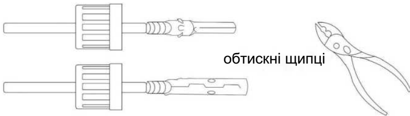
Рис. 2.13. Обтискання металевого контактного наконечника
