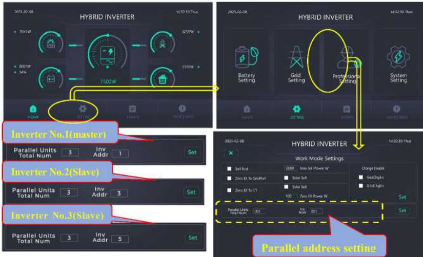
Рис. 4.4. Спосіб налаштування номерів і адрес трьох інверторів, з'єднаних паралельно
