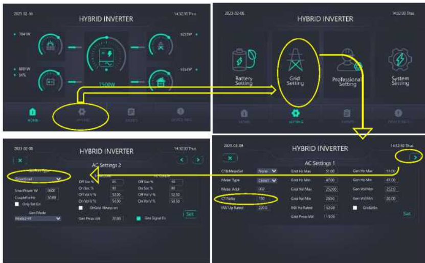
Рис. 3.17. Порядок налаштування резервного навантаження і коефіцієнта трансформації
